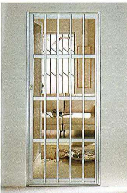
SISSA (Drehflügel) UND FISSA (Fest) - horizontale und vertikale rechteckige Profile. Bautiefe 50 mm. Zwei drehbare Stahlrundstäbe à ø 8 mm pro Profil
